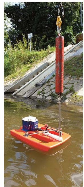
Abb. 7: Abflussmessung mit ADCP-Messboot (© RP Darmstadt)
