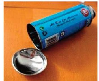
**Abb. 4:** Gaskartusche nach Explosion
