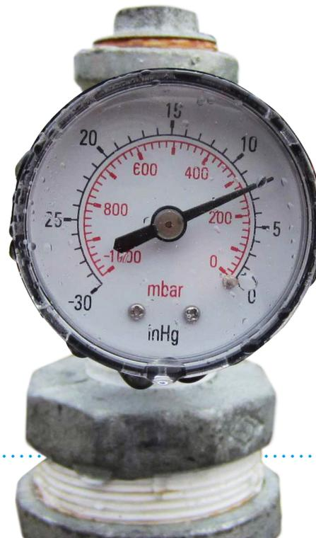
Mit Unterdruck werden die Schadstoffe aus dem erhitzten Boden gesaugt
