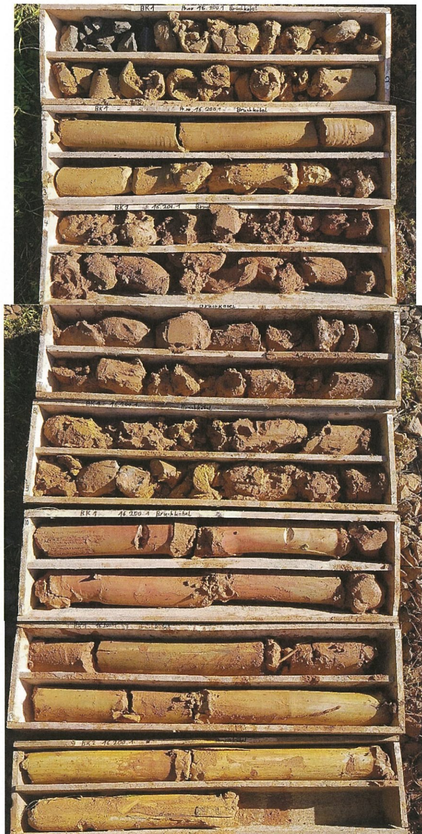
Bild 23: Bohrgut BK 1, Tiefenstufe 0,00 – 15,50 m
