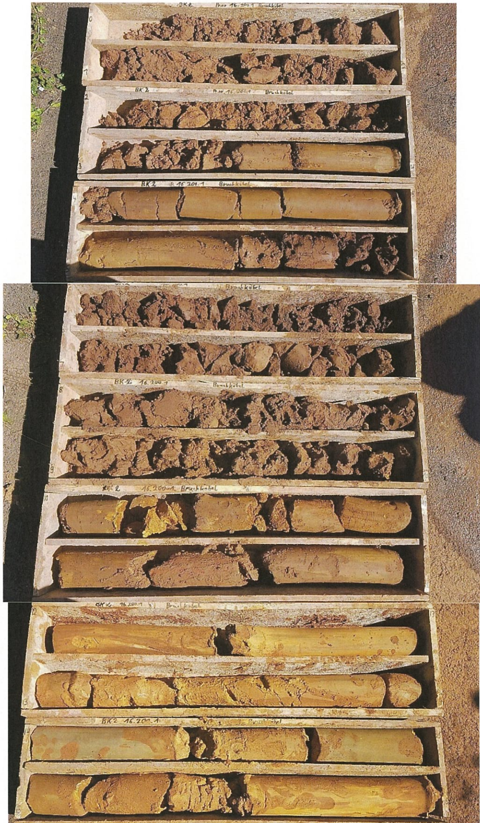
Bild 24: Bohrgut BK 2, Tiefenstufe 0,00 – 16,00 m
