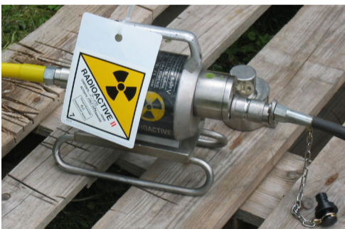
Durchstrahlungsprüfung mit Ir-192
