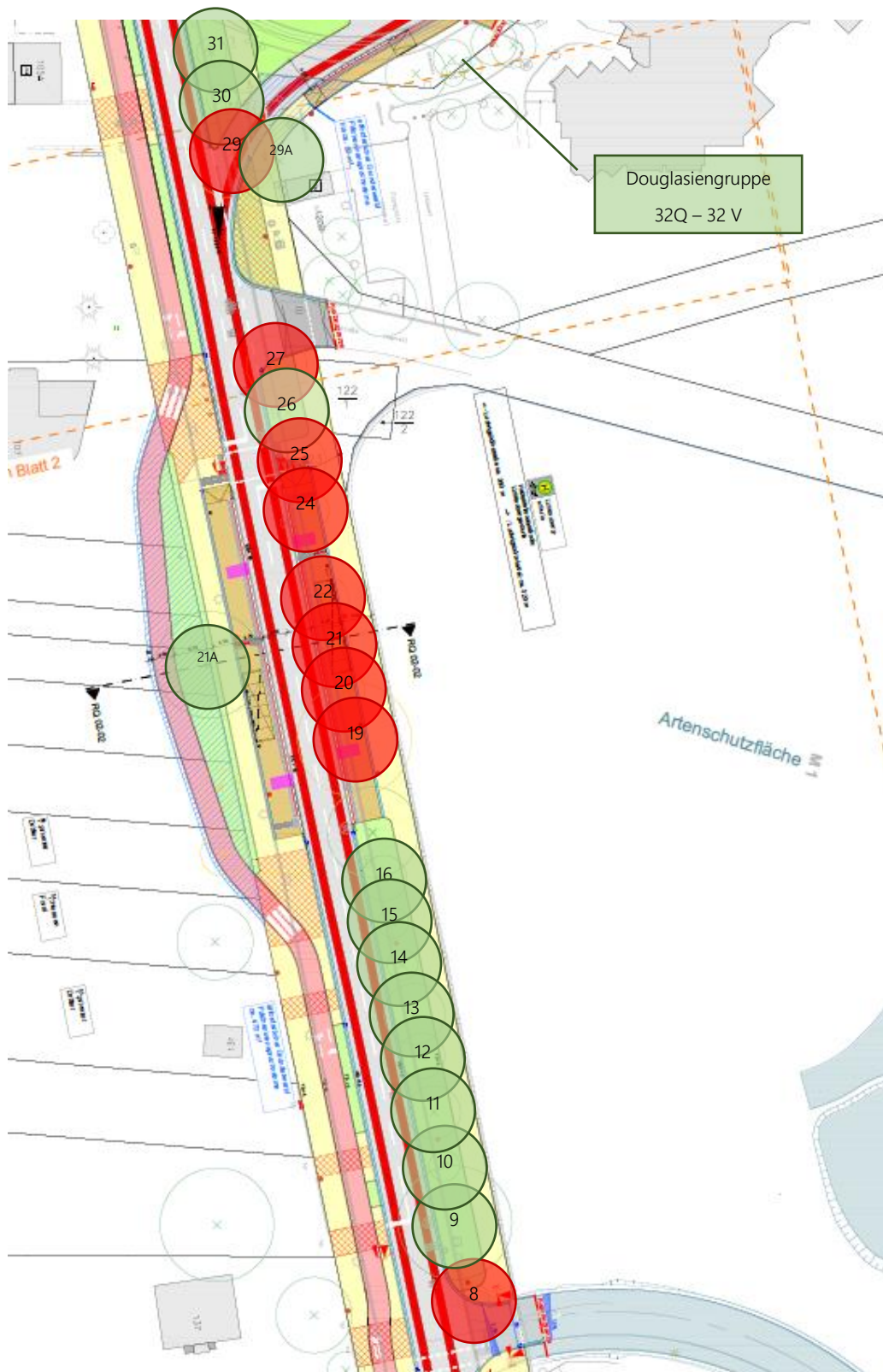
Abbildung 7: Planausschnitt Vorabzug Entwurfsplanung, Ludwigshöhstraße Teil 2, bezüglich ihrer Verpflanzbarkeit begutachtete Bäume rot markiert; Quelle: HEAG mobilo GmbH
