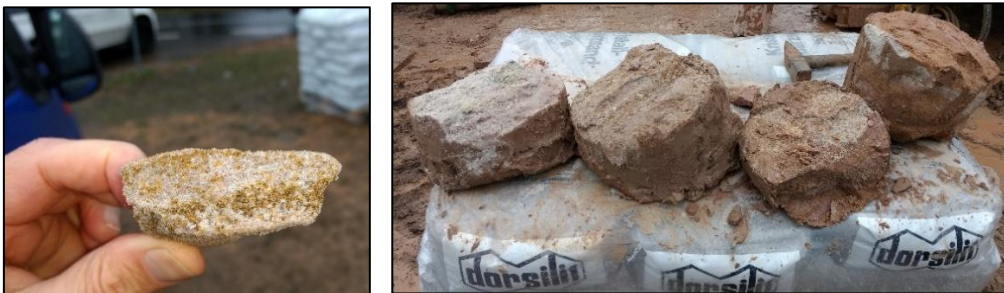
Abb. 5: Zersetzter Sandstein bei 17 m (links) und kompakter Sandstein zwischen 17 m und 18 m (rechts)
