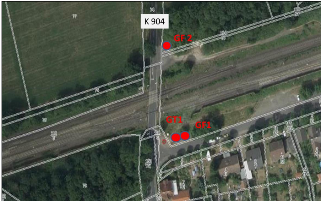
Abb. 2: Lage der neu errichteten Grundwassermessstellen GF1 und GF2 (flach, quartärer Grundwasserleiter) und GT1 (tief)
