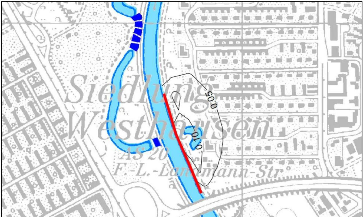
Abbildung 1: Einfluss einer Spundwand auf die Grundwasserstände
