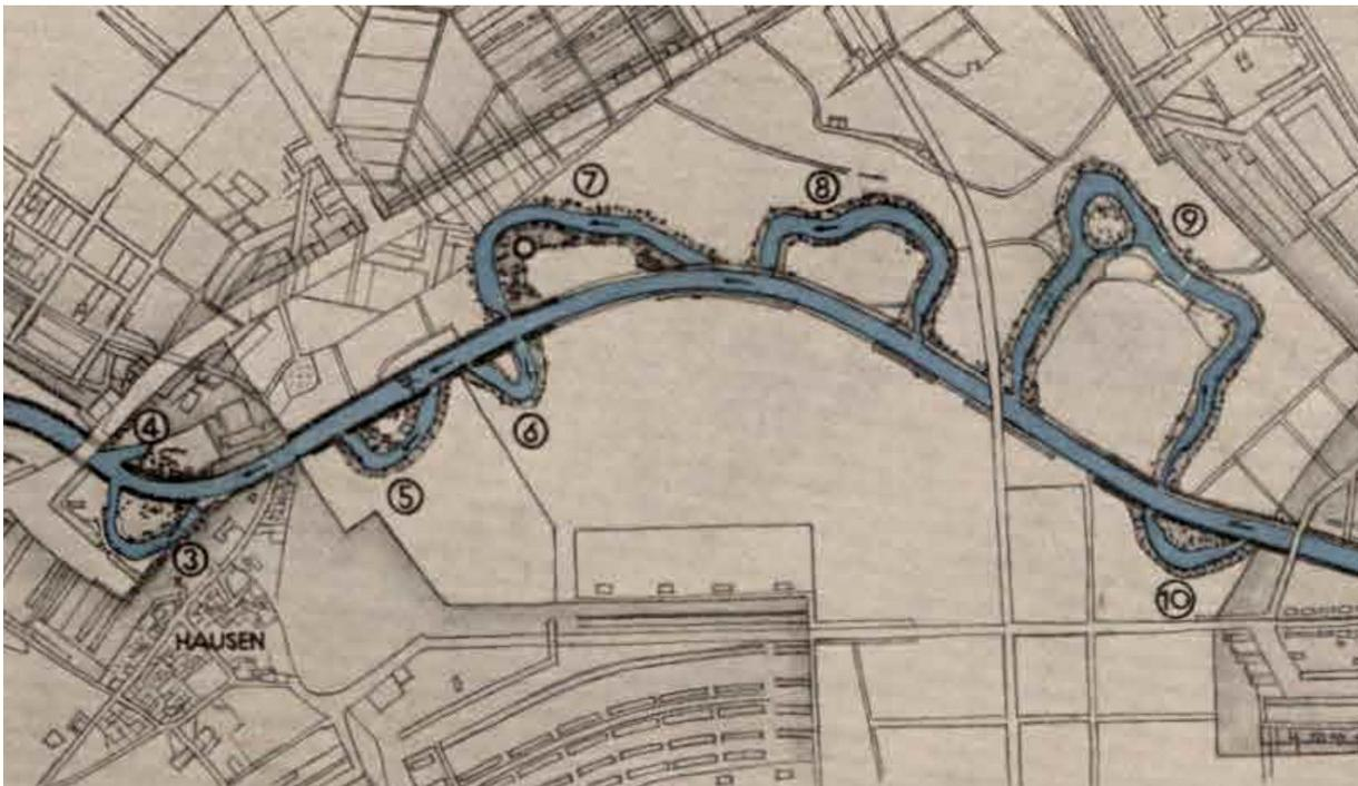
Abbildung: Die Nidda im Bereich Hausen und Praunheim nach der Regulierung. In der Denkschrift zur Erhaltung der alten Nidda nummerierte Max Bromme die Flussschleifen, die bei der Niddaregulierung vom Fluss abgetrennt worden waren. Diese Nummerierung ist heute noch gebräuchlich. Der idealisierte Plan enthält auch geplante Wohngebiete und Straßen. [U#Bromme#]
