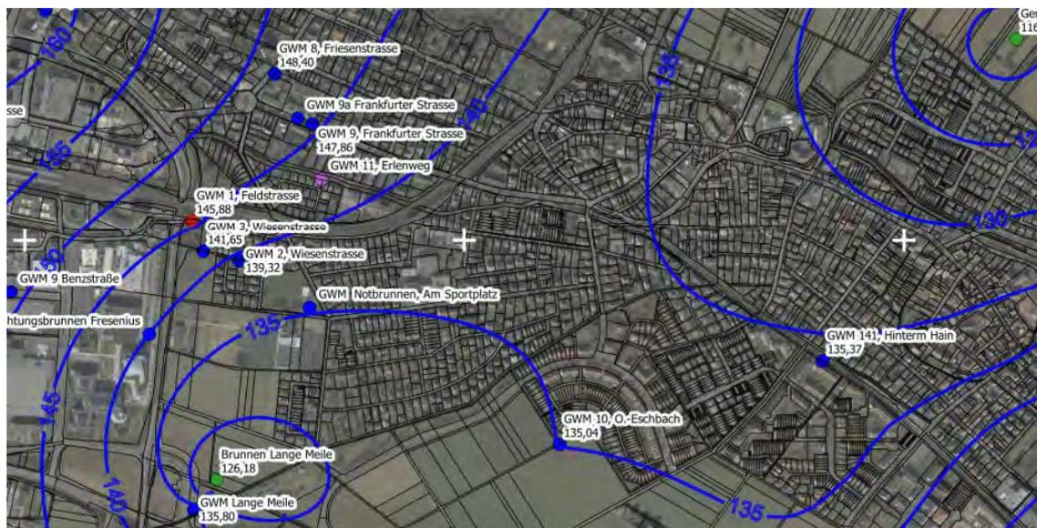
Abbildung 9: Auszug aus dem Grundwasserhöhengleichenplan für den 03.11.2020 [15]
